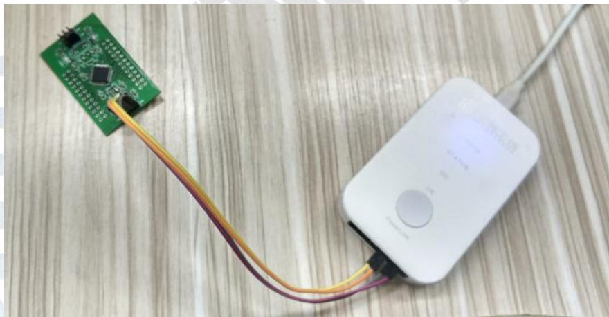
图 2.4.1.7 Power Writer 连接目标芯片
